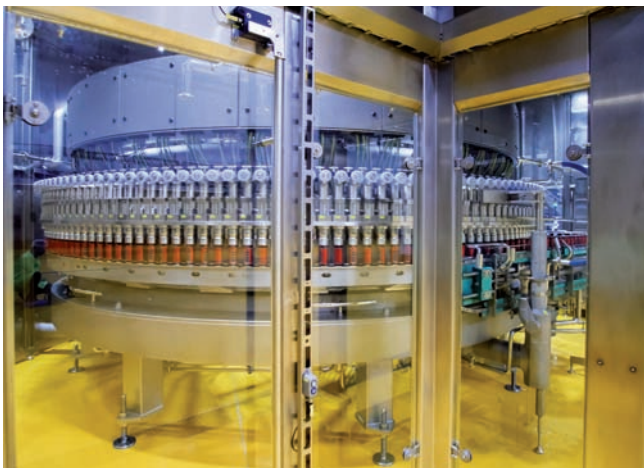
120 000 plechoviek energetického nápoja HELL ENERGY každú hodinu – to je výkon modernej plniacej linky.
